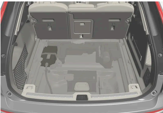
차량이 마일드 하이브리드 타입인 경우에는 트렁크 좌측에 48 V 보조 배터리가 있습니다. 48 V 보조 배터리는 공인 서비스 센터만 취급해야 합니다.
