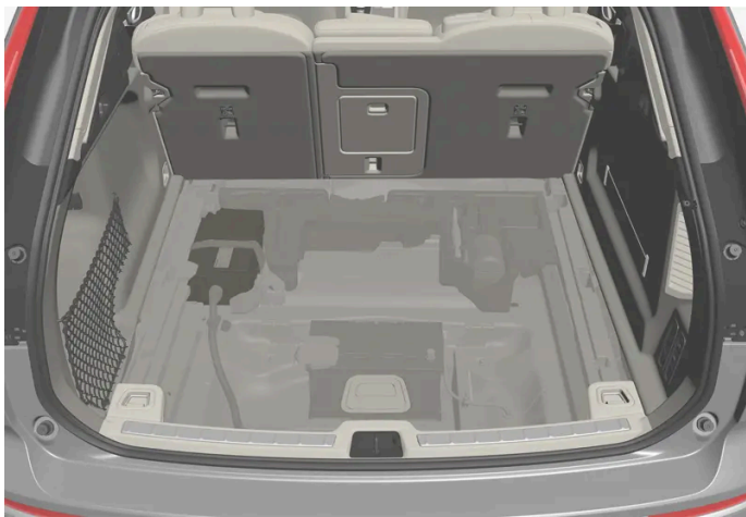
마일드 하이브리드 유형의 차량은 적재 공간 아래에 48 V 보조 배터리가 있습니다. 배터리는 공인 서비스 센터만 취급해야 합니다.
