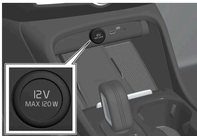
12V-aansluiting in tunnelconsole, voorin.
