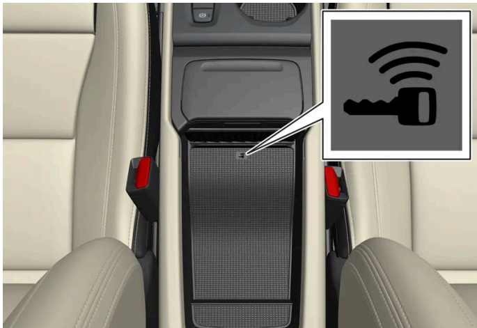
Positie back-uplezer in de tunnelconsole.
