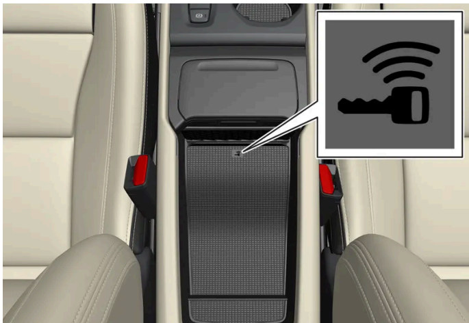
Positie back-uplezer in de tunnelconsole.
