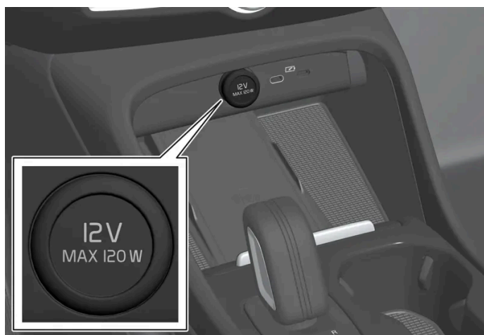
12V-aansluiting in tunnelconsole, voorin.
