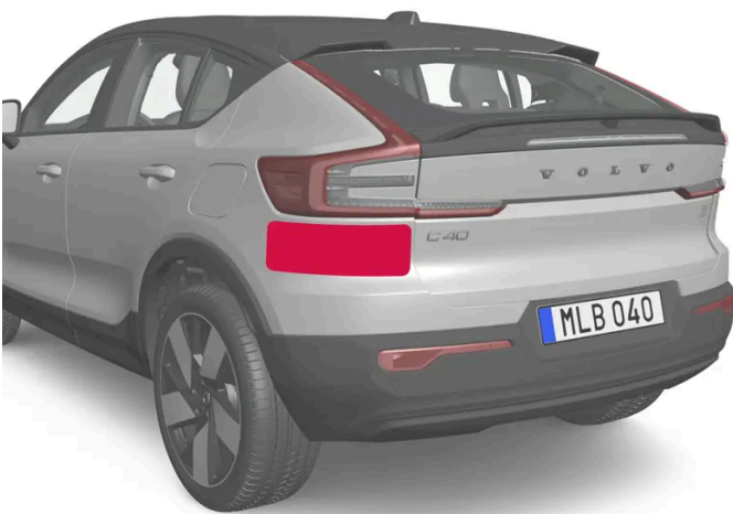
Locatie van de radarsensoren aan de achterzijde
