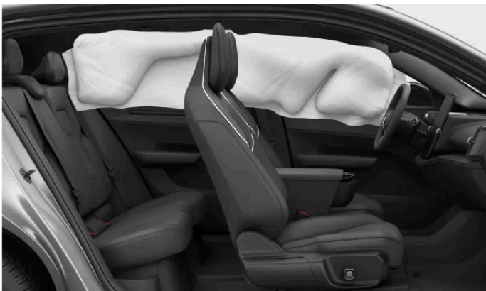
Opblaasgordijn geactiveerd aan één zijde van de auto.
