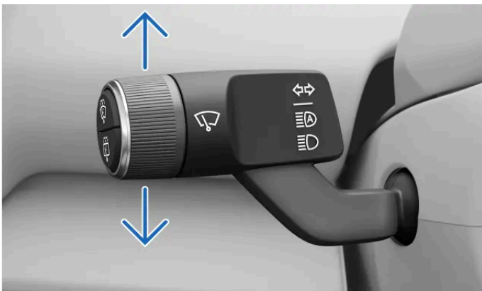
De richtingaanwijzers op de linkerhendel
