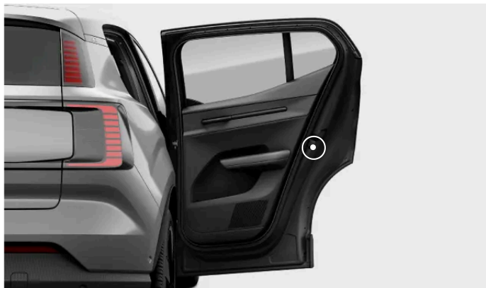
Positie van de schakelaar van het kinderslot.
