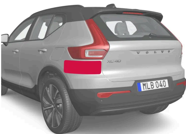
Locatie van de radarsensoren aan de achterzijde
