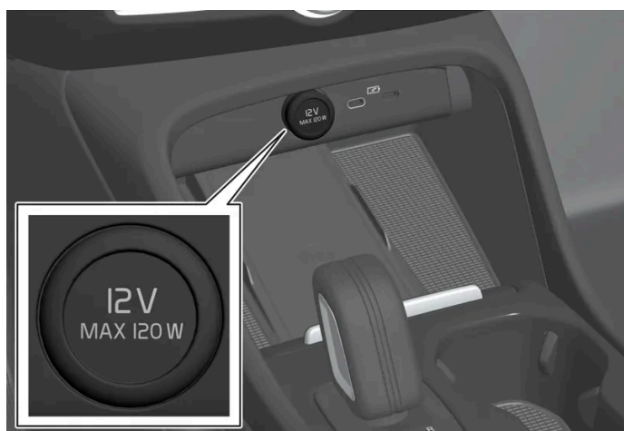
12V-aansluiting in tunnelconsole, voorin.
