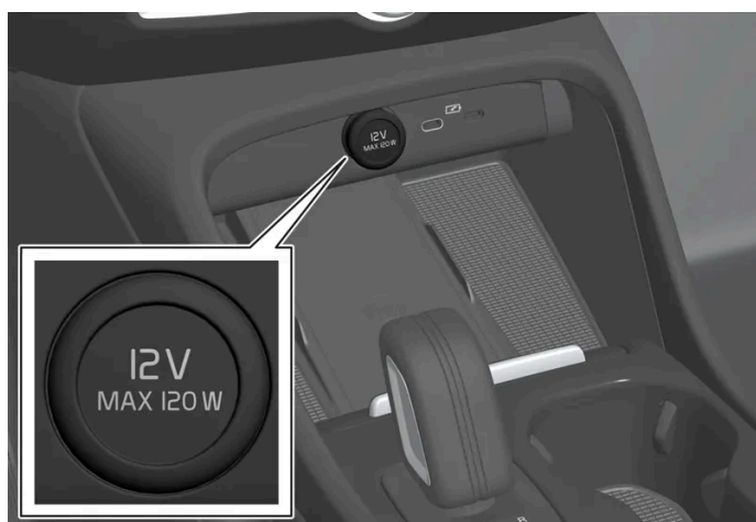
12V-aansluiting in tunnelconsole, voorin.
