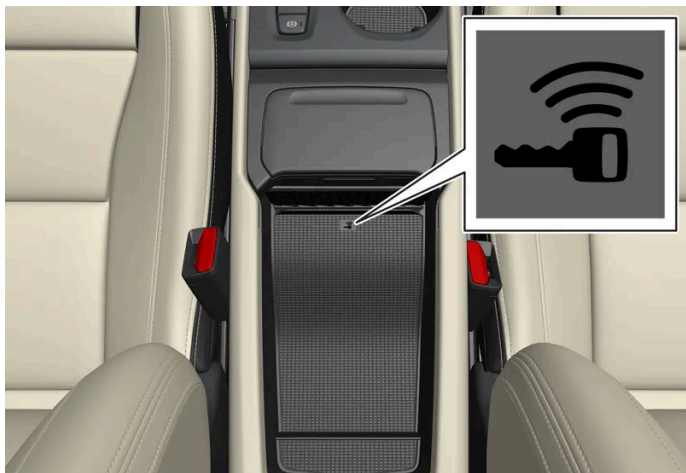
Positie back-uplezer in de tunnelconsole.
