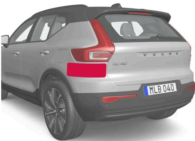
Locatie van de radarsensoren aan de achterzijde
