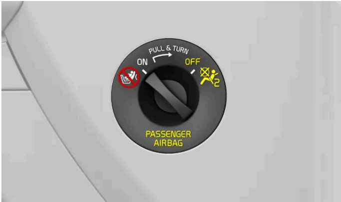
Airbags ingeschakeld Gebruik deze stand altijd wanneer een naar voren gerichte passagier, kind of volwassene, op de stoel zit.
