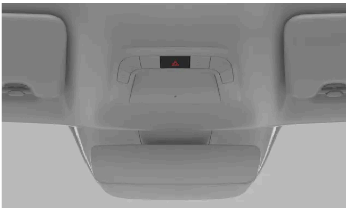
De knop voor de gevaarlichten bevindt zich in de plafondconsole
