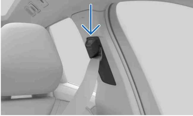
Bovenste bevestigingspunt van de stoel
