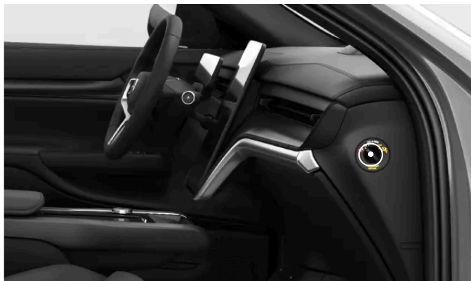
Locatie van de schakelaar voor de passagiersairbag
