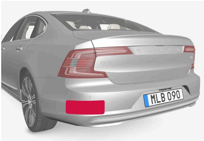
Locatie van de radarsensoren aan de achterzijde
