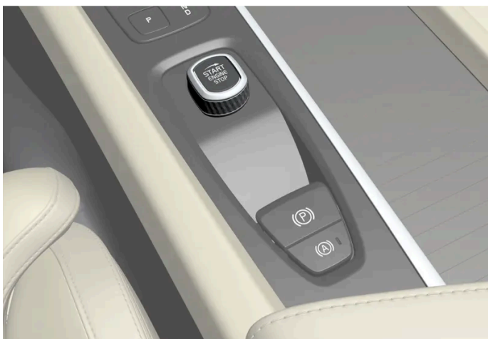
De startknop op de tunnelconsole.
