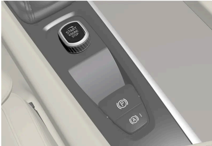
De startknop op de tunnelconsole.
