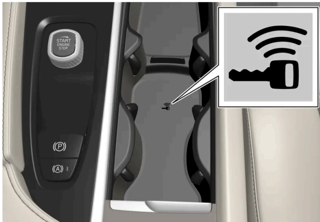
Positie back-uplezer in de tunnelconsole.
