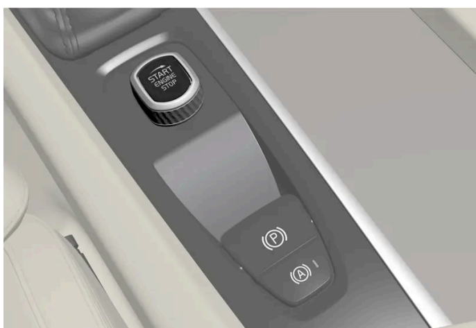
De startknop op de tunnelconsole.
