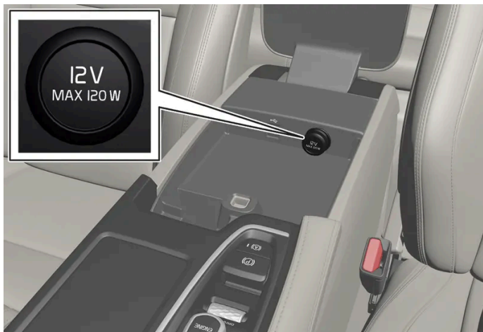
12V-aansluiting in tunnelconsole, voorin.
