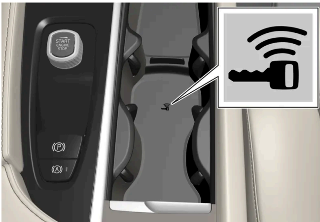
Positie back-uplezer in de tunnelconsole.
