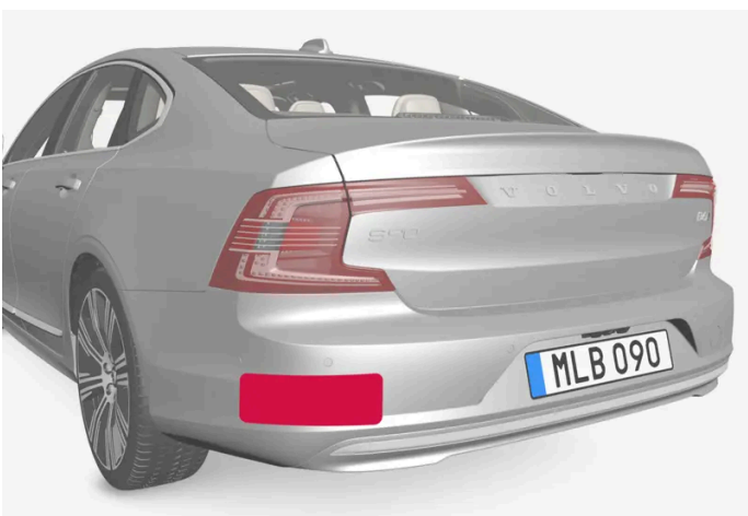
Locatie van de radarsensoren aan de achterzijde
