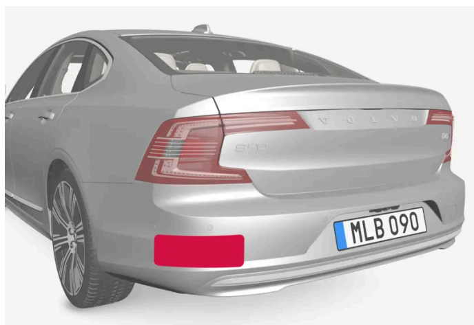
Locatie van de radarsensoren aan de achterzijde
