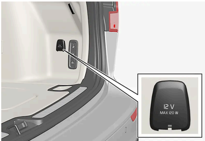
12V-aansluiting in kofferbak/bagageruimte*.
