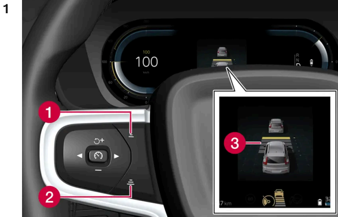
Bedieningselementen voor het tijdsverschil.
