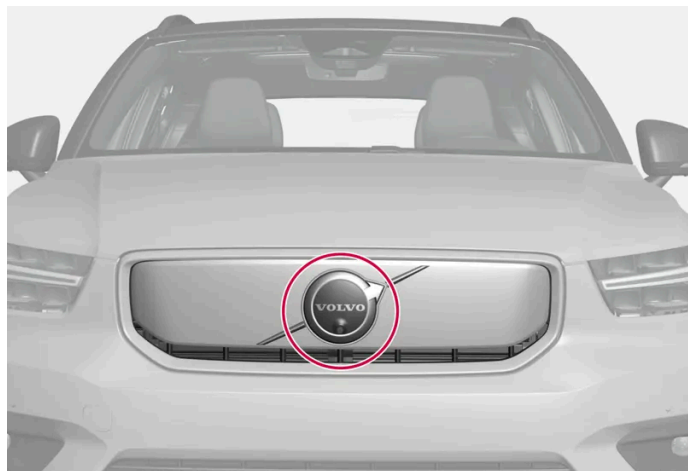
Positie van de voorste radarsensor
