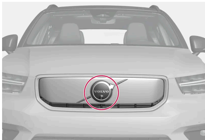
Positie van de voorste radarsensor
