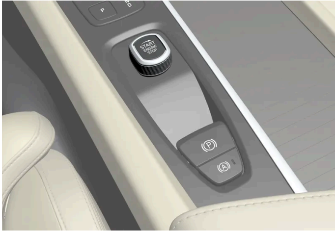
De startknop op de tunnelconsole.
