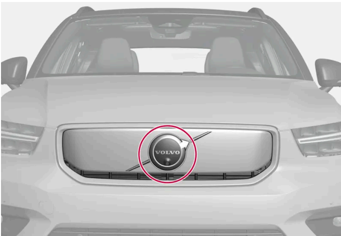
Positie van de voorste radarsensor
