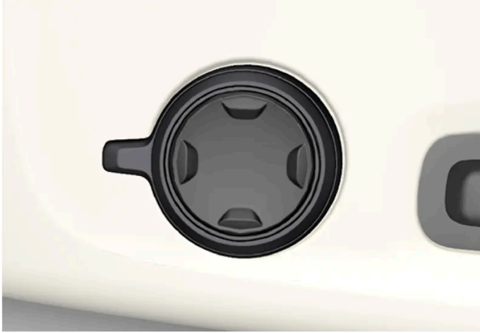
Multifunctionele bediening, op de zijkant van het zitkussen van de stoel.
