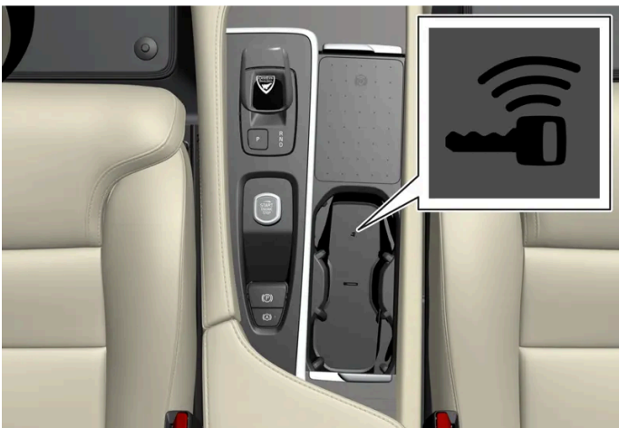
Positie back-uplezer in de tunnelconsole.
