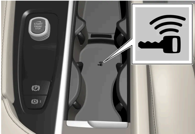
Positie back-uplezer in de tunnelconsole.
