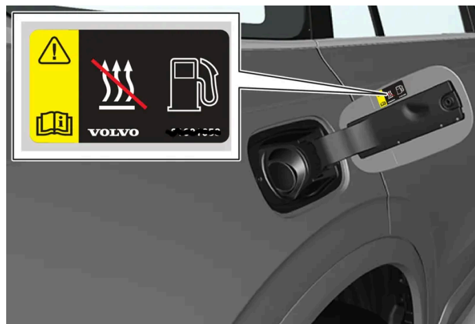
Waarschuwingsticker op tankvulklep.
