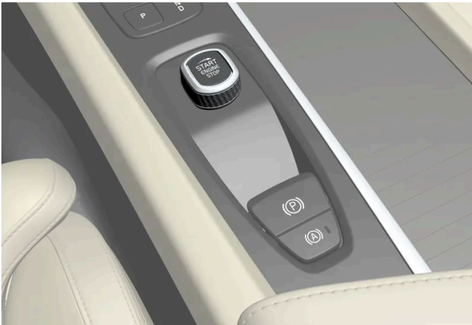
De startknop op de tunnelconsole.
