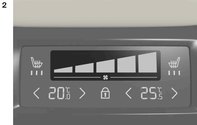
Ventilatorregeling op klimaatpaneel achter op tunnelconsole.
