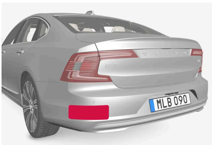
Locatie van de radarsensoren aan de achterzijde
