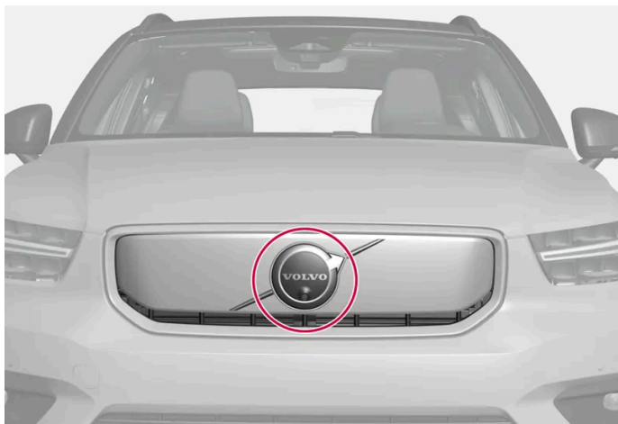
Positie van de voorste radarsensor
