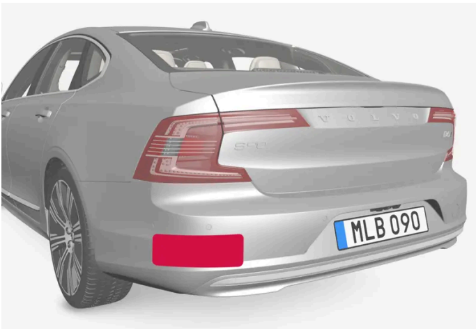
Locatie van de radarsensoren aan de achterzijde
