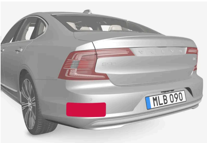
Locatie van de radarsensoren aan de achterzijde
