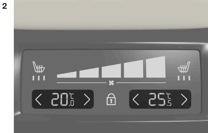
Temperatuurregeling op klimaatpaneel achter op tunnelconsole.
