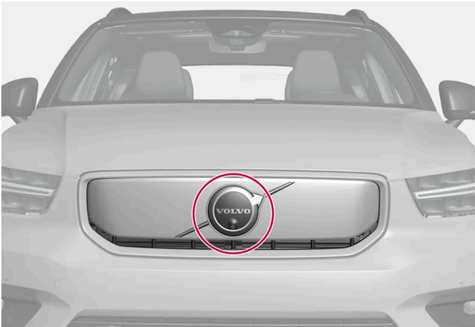
Positie van de voorste radarsensor
