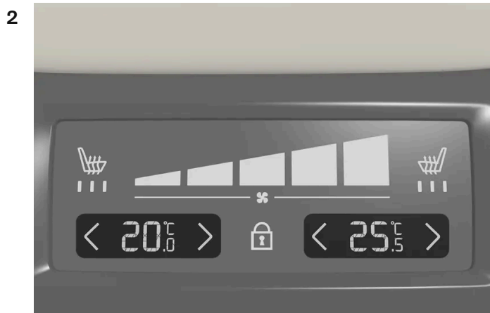
Temperatuurregeling op klimaatpaneel achter op tunnelconsole.
