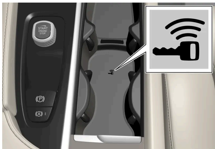
Positie back-uplezer in de tunnelconsole.
