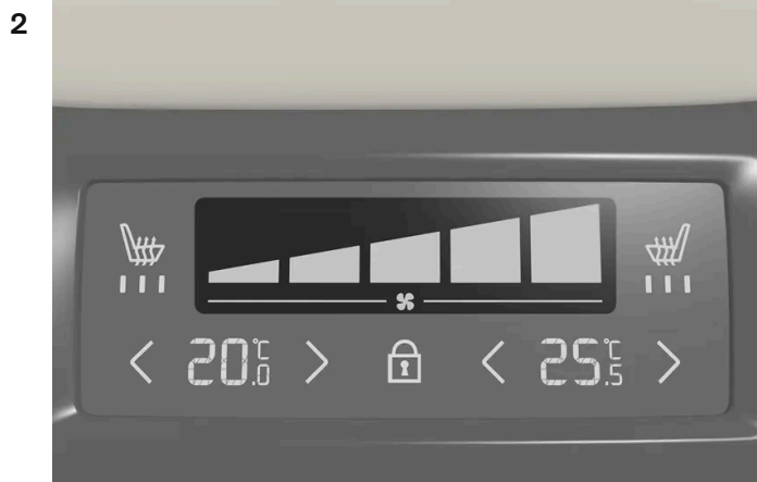
Ventilatorregeling op klimaatpaneel achter op tunnelconsole.
