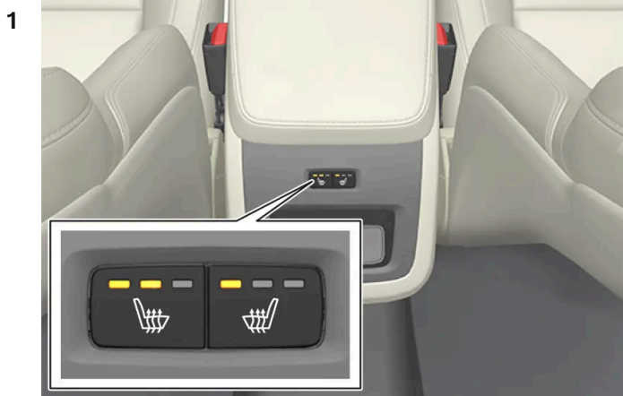
Knoppen voor elektrische achterbankverwarming achter op tunnelconsole.
