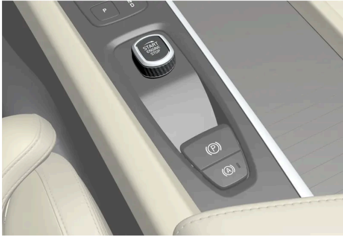
De startknop op de tunnelconsole.
