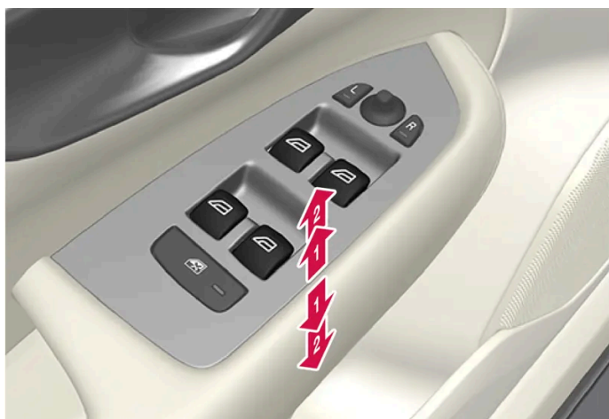
Bedieningsknoppen elektrisch bedienbare ruiten.
