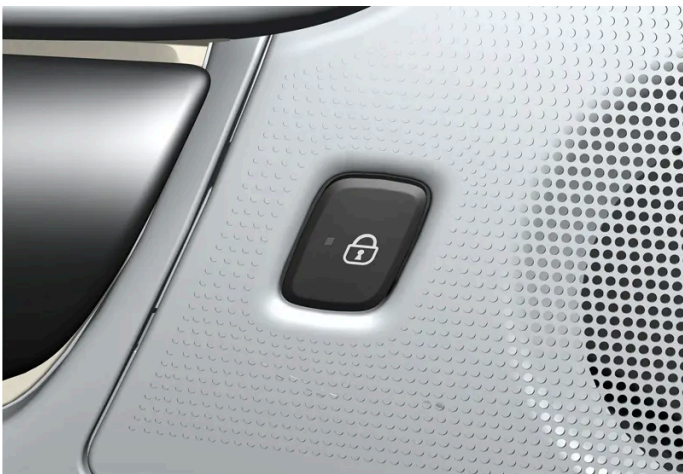
Knop voor vergrendelen in achterportier met led.
