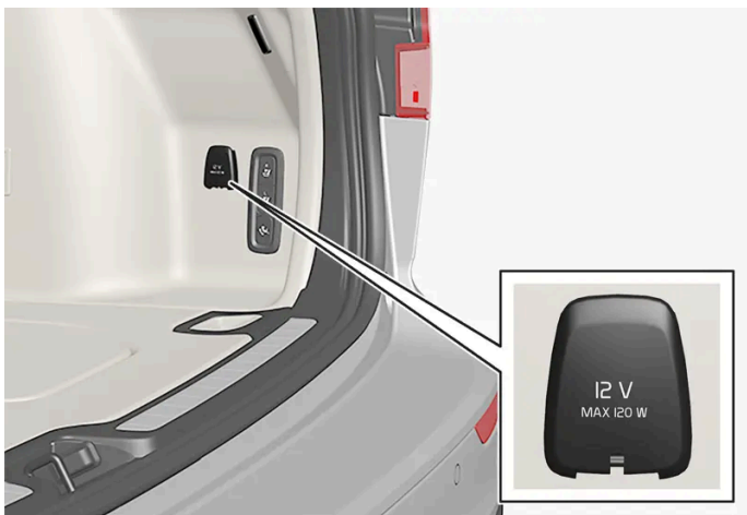
12V-aansluiting in kofferbak/bagageruimte*.
