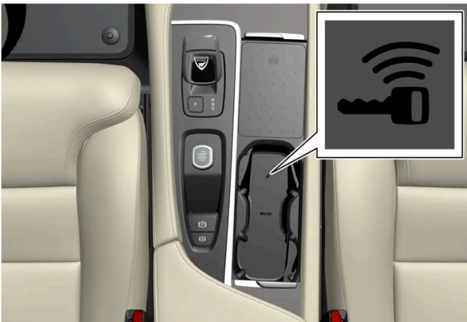
Positie back-uplezer in de tunnelconsole.
