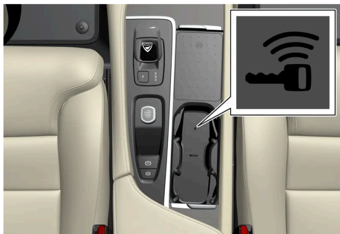
Positie back-uplezer in de tunnelconsole.
