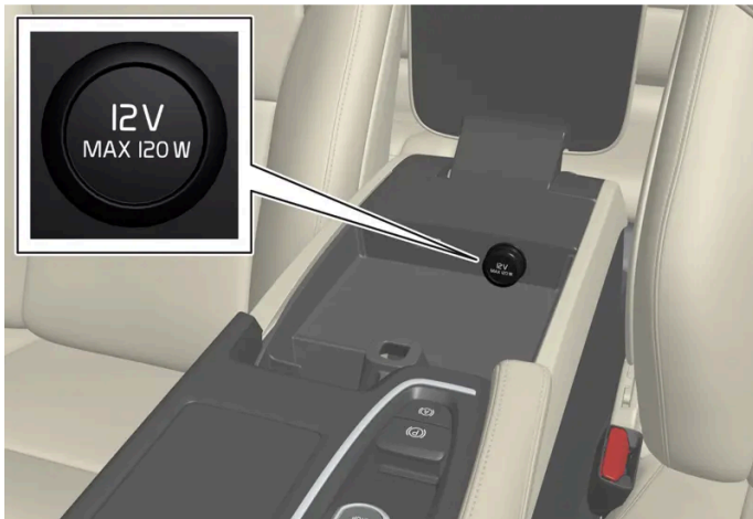
12V-aansluiting in tunnelconsole, voorin.
