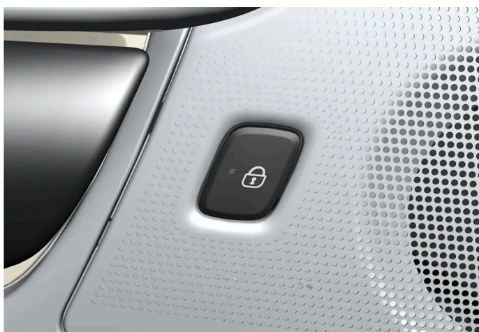
Knop voor vergrendelen in achterportier met led.
