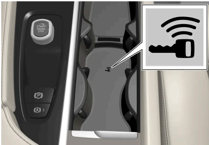
Positie back-uplezer in de tunnelconsole.
