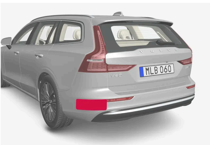
Locatie van de radarsensoren aan de achterzijde
