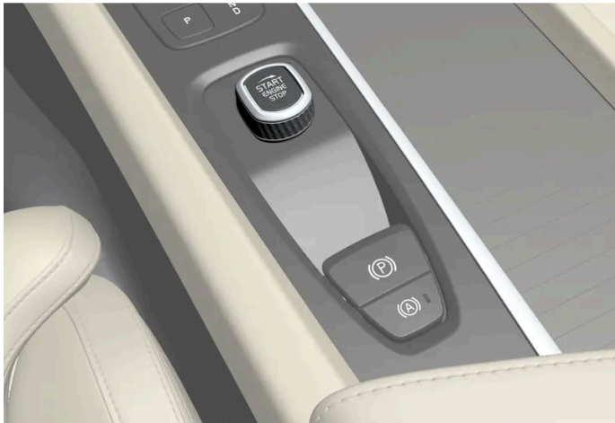
De startknop op de tunnelconsole.
