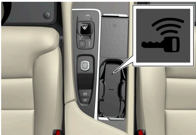
Positie back-uplezer in de tunnelconsole.
