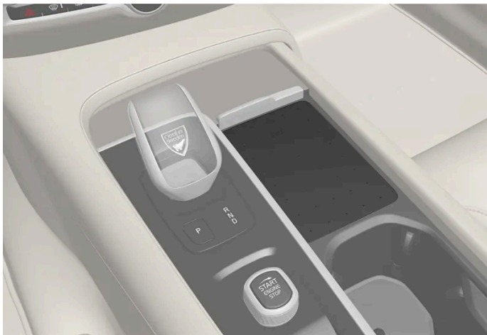
Draadloze oplader in de tunnelconsole.
