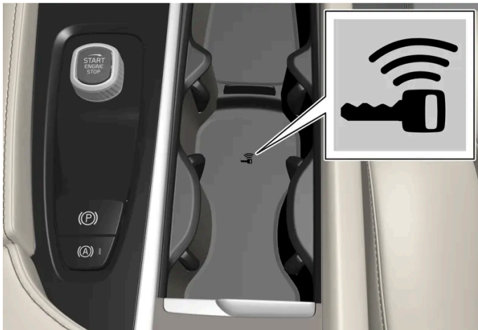
Positie back-uplezer in de tunnelconsole.
