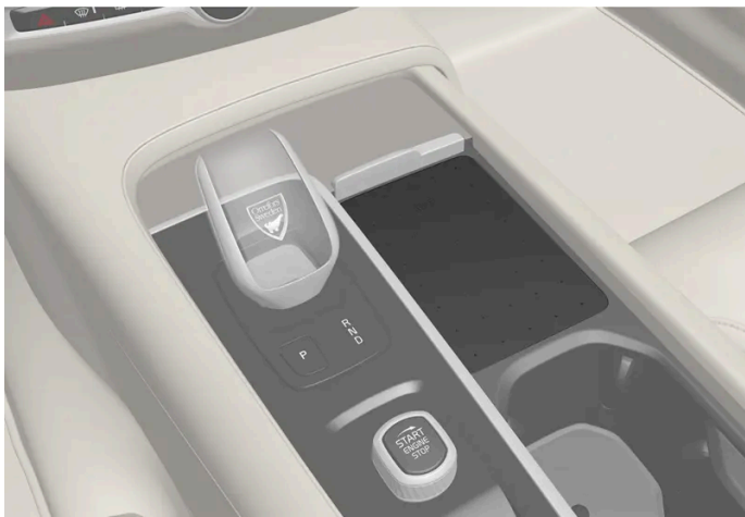
Draadloze oplader in de tunnelconsole.
