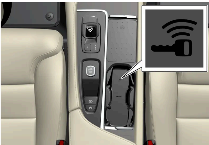
Positie back-uplezer in de tunnelconsole.
