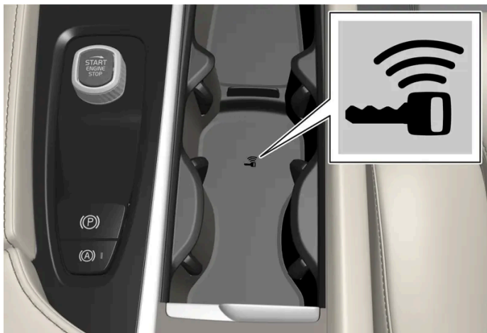
Positie back-uplezer in de tunnelconsole.
