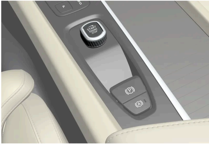
De startknop op de tunnelconsole.
