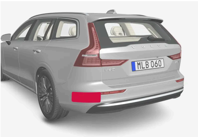
Locatie van de radarsensoren aan de achterzijde
