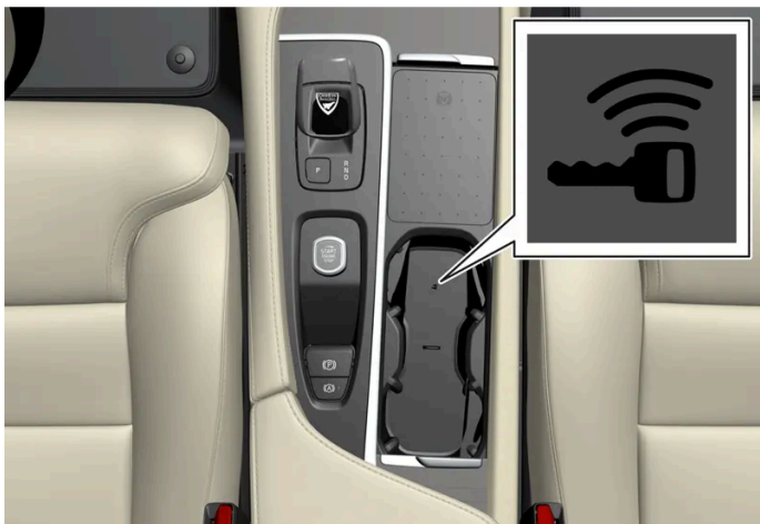
Positie back-uplezer in de tunnelconsole.
