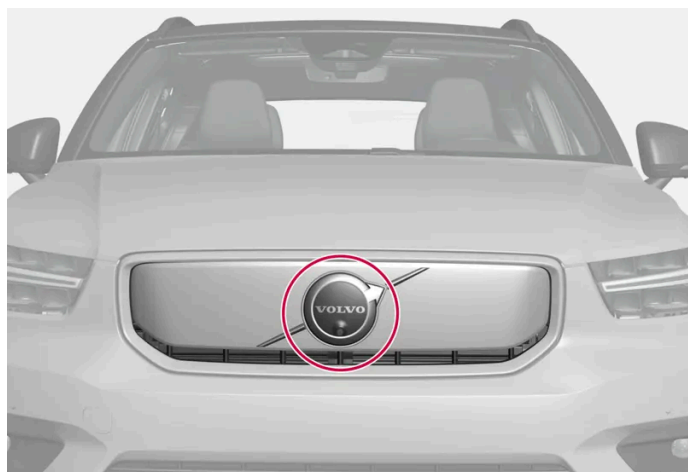
Positie van de voorste radarsensor
