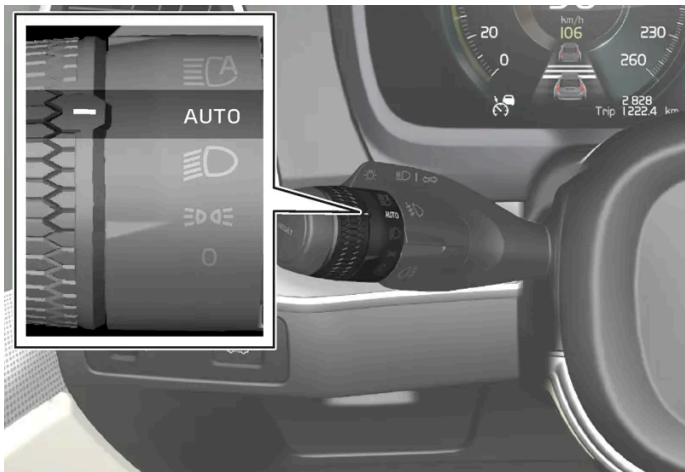
De draairing van de stuurhendel in stand AUTO .
