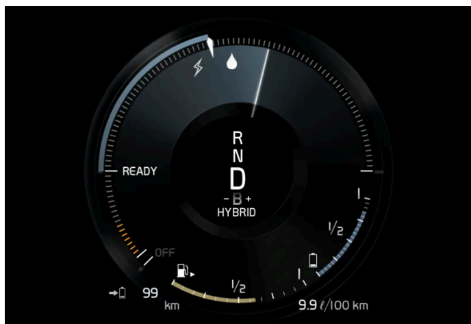
Bestuurdersdisplay bij aandrijving met elektromotor en verbrandingsmotor.
