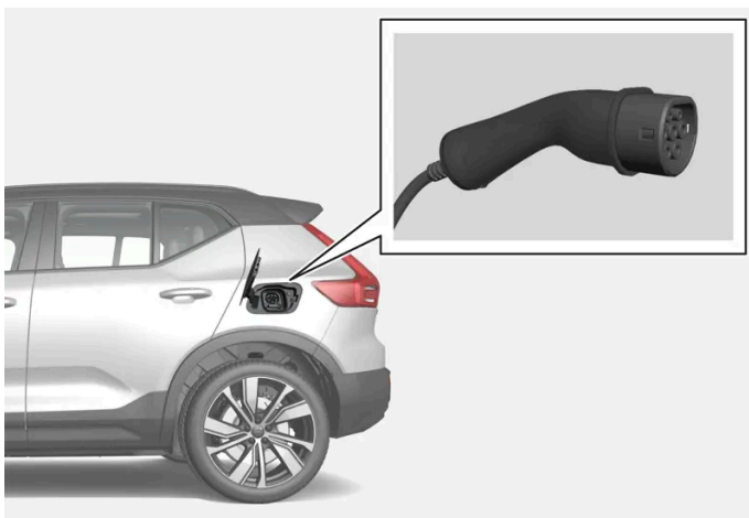
Laadkabelstekker en laadaansluiting.
