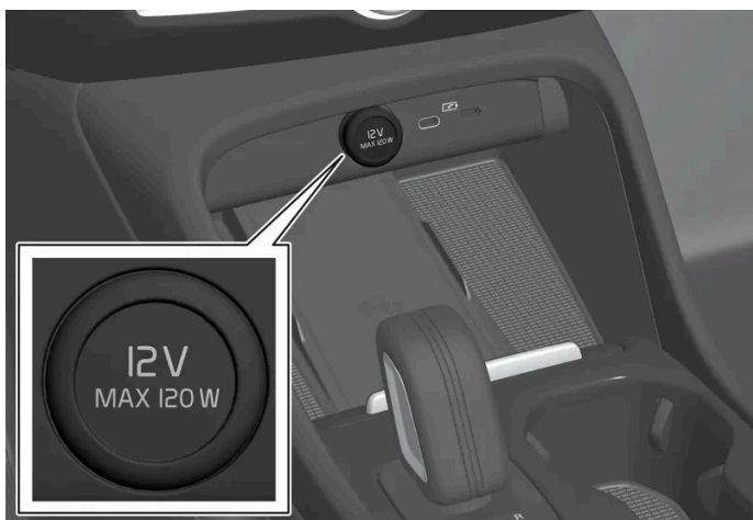
12V-aansluiting in tunnelconsole, voorin.
