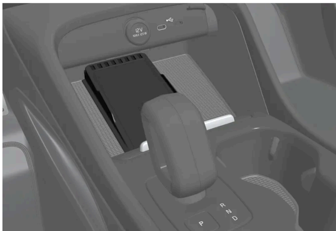
Draadloze telefoonoplader vóór de schakelhendel
