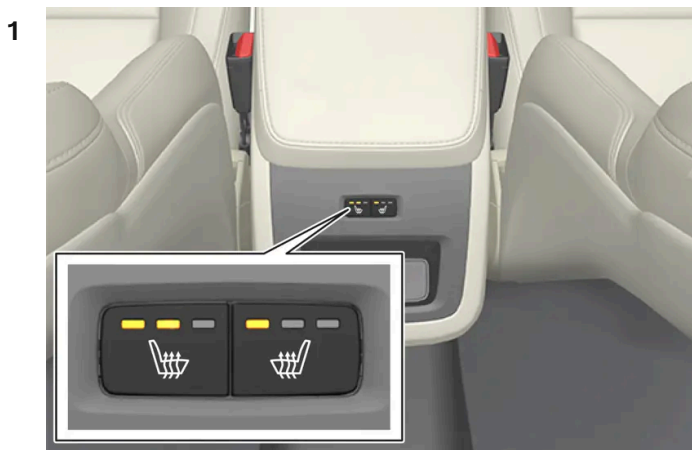
Knoppen voor elektrische achterbankverwarming achter op tunnelconsole.
