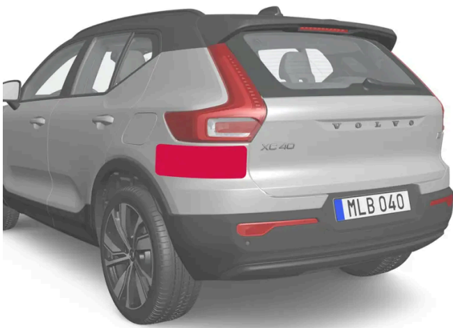
Locatie van de radarsensoren aan de achterzijde
