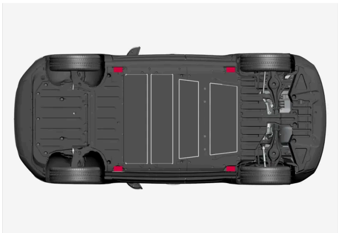
Hefpunten van de auto voor omhoog brengen met een krik.
