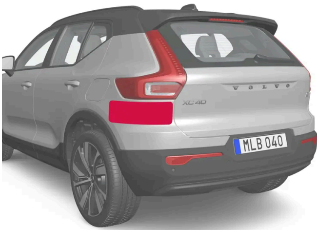
Locatie van de radarsensoren aan de achterzijde
