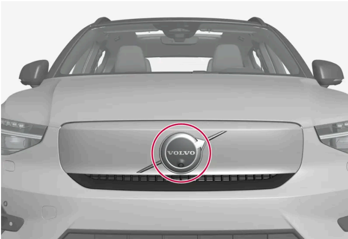
Positie van de voorste radarsensor
