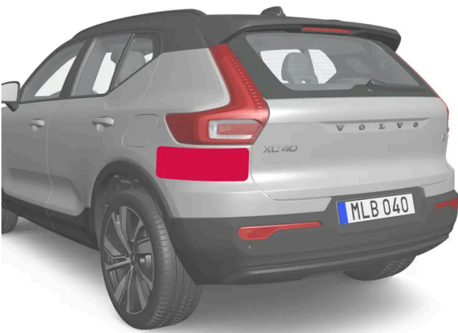
Locatie van de radarsensoren aan de achterzijde
