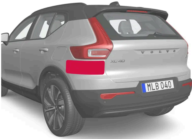
Locatie van de radarsensoren aan de achterzijde
