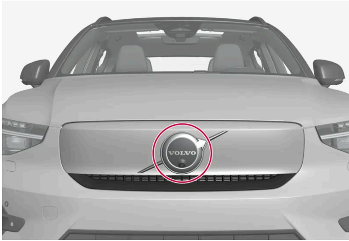
Positie van de voorste radarsensor
