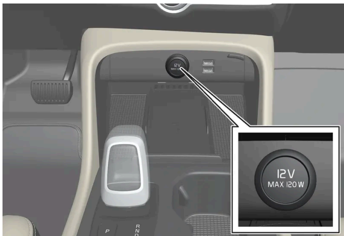
12V-aansluiting in tunnelconsole, voorin.
