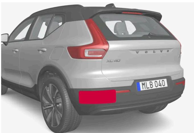
Locatie van de radarsensoren aan de achterzijde
