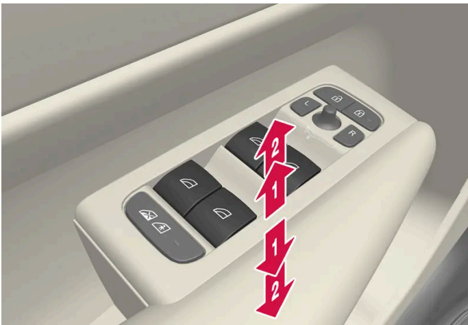
Bedieningsknoppen elektrisch bedienbare ruiten.
