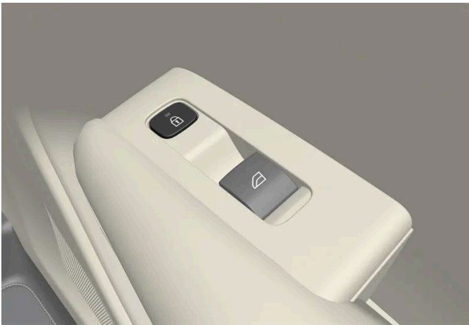
Knop voor vergrendelen in achterportier met led.
