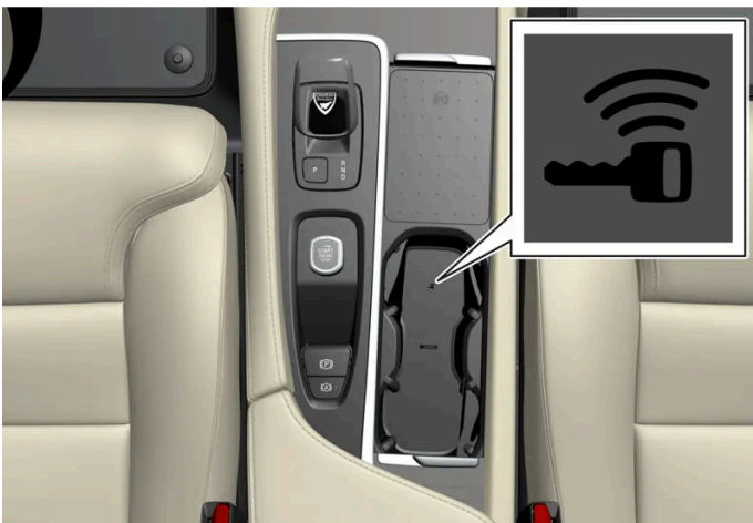
Positie back-uplezer in de tunnelconsole.
