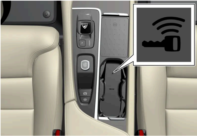
Positie back-uplezer in de tunnelconsole.
