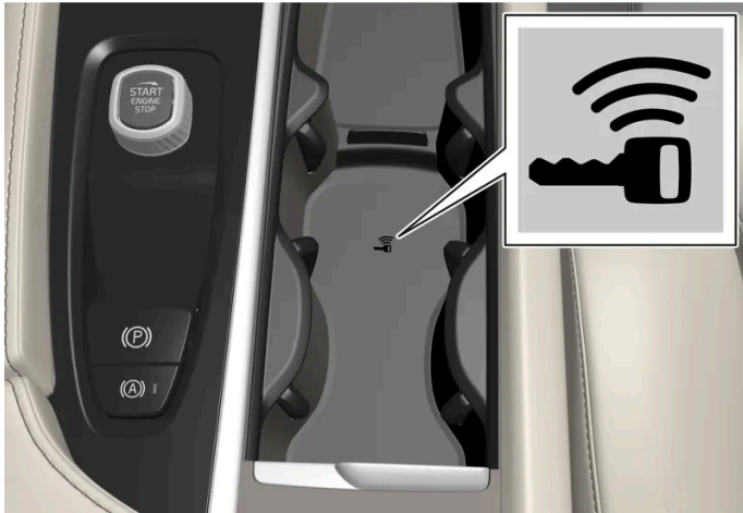
Positie back-uplezer in de tunnelconsole.
