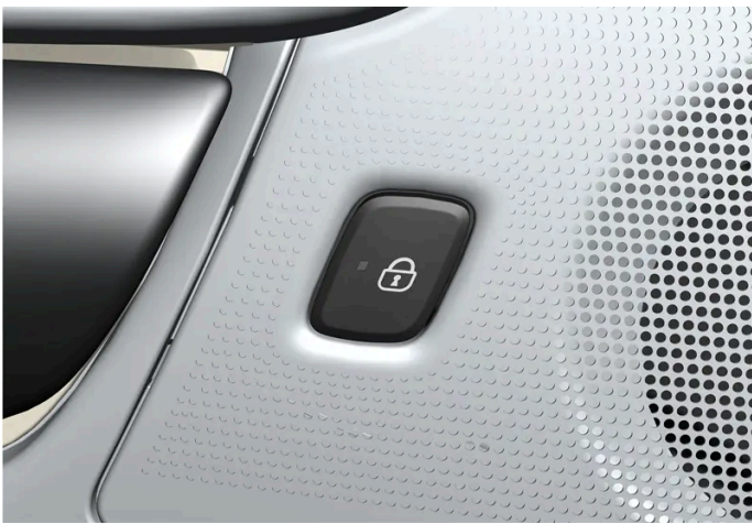
Knop voor vergrendelen in achterportier met led.
