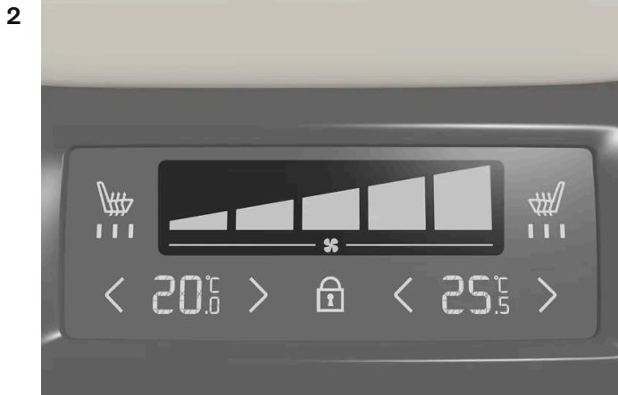
Ventilatorregeling op klimaatpaneel achter op tunnelconsole.
