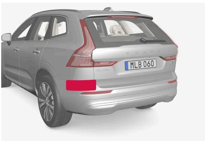
Locatie van de radarsensoren aan de achterzijde
