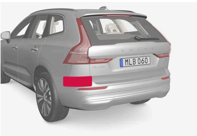
Locatie van de radarsensoren aan de achterzijde
