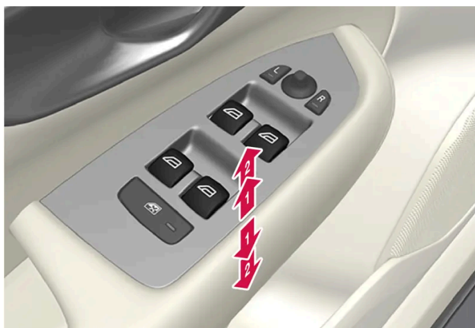
Bedieningsknoppen elektrisch bedienbare ruiten.
