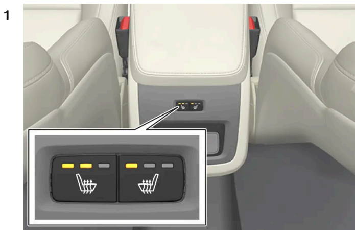
Knoppen voor elektrische achterbankverwarming achter op tunnelconsole.
