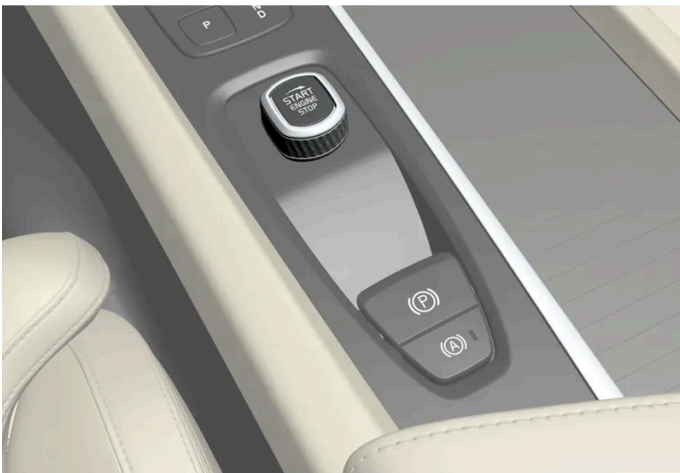
De startknop op de tunnelconsole.
