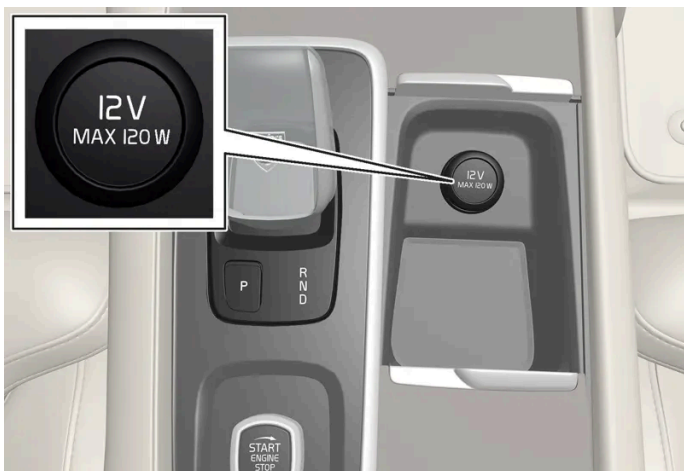
De voorste aansluiting van de tunnelconsole voor auto's zonder draadloze telefoonoplader*.
