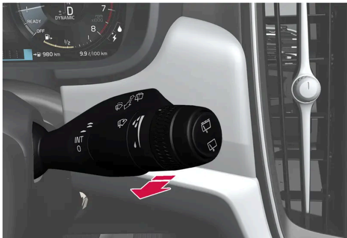
Sproeifunctie, rechter stuurhendel.
