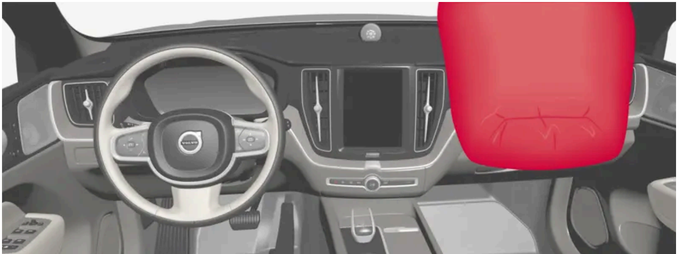
Airbag voor de voorstoel aan passagierszijde.
