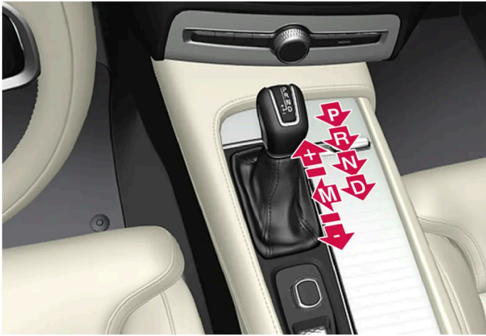
Overzicht grote schakelhendel en schakelstanden.
