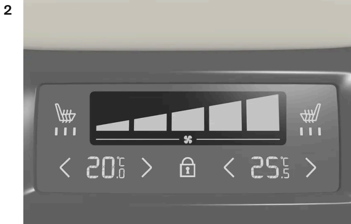
Ventilatorregeling op klimaatpaneel achter op tunnelconsole.
