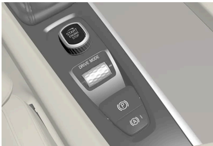
De startknop op de tunnelconsole.
