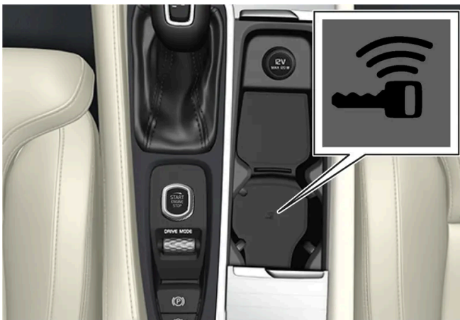
Positie back-uplezer in de tunnelconsole.
