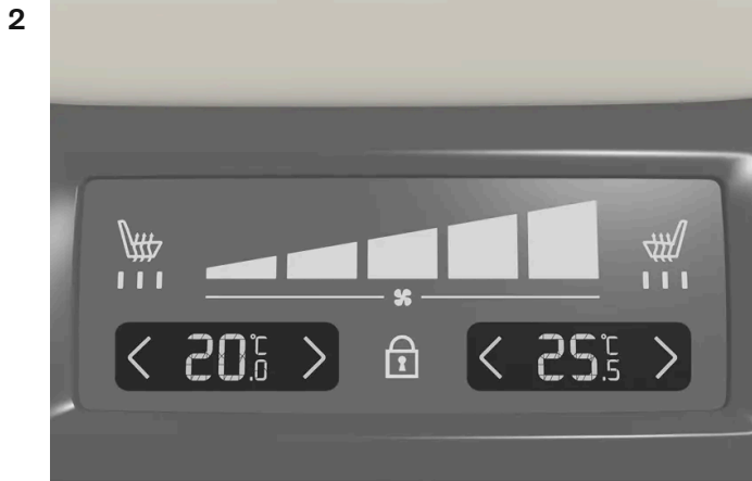
Temperatuurregeling op klimaatpaneel achter op tunnelconsole.
