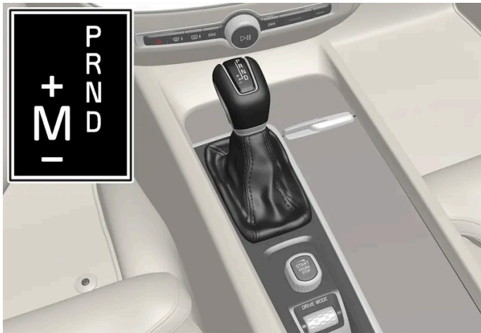
Overzicht voor de grote schakelhendel en het schakelpatroon op bestuurdersdisplay.
