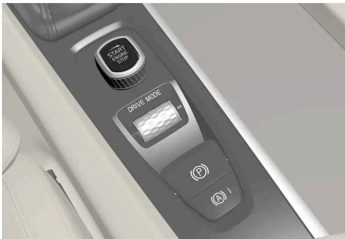
De startknop op de tunnelconsole.
