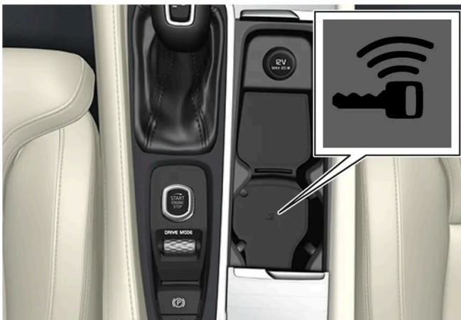
Positie back-uplezer in de tunnelconsole.
