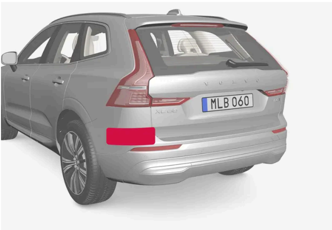
Locatie van de radarsensoren aan de achterzijde
