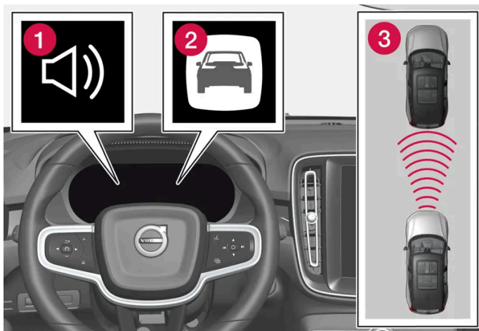
Geluidssignaal en symbool voor Collision Warning
