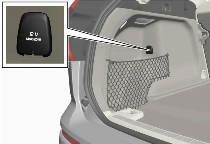
12V-aansluiting in bagageruimte*.
