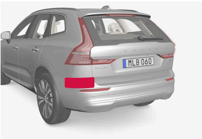
Locatie van de radarsensoren aan de achterzijde
