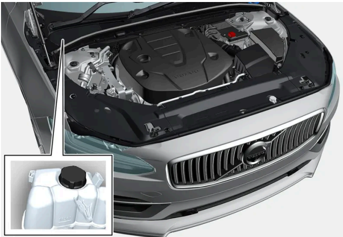
Expansiereservoir voor koelsysteem, auto met het stuur rechts.
