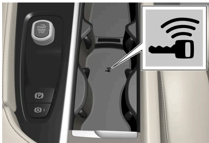
Positie back-uplezer in de tunnelconsole.
