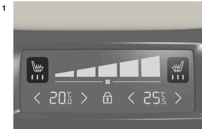
Indicatie en regeling stoelverwarming op klimaatpaneel achter op tunnelconsole.
