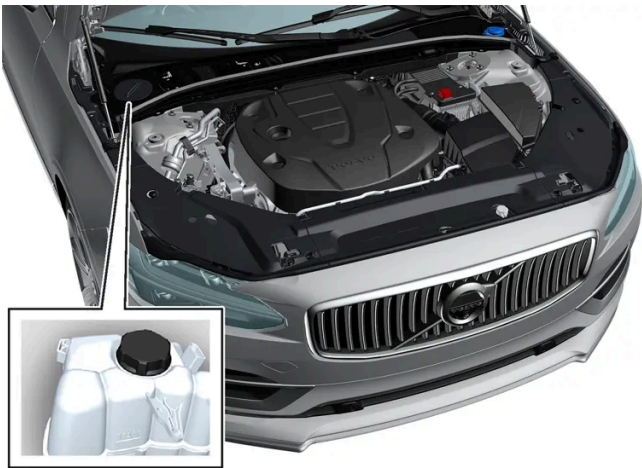
Expansiereservoir voor koelsysteem, auto met het stuur links.
