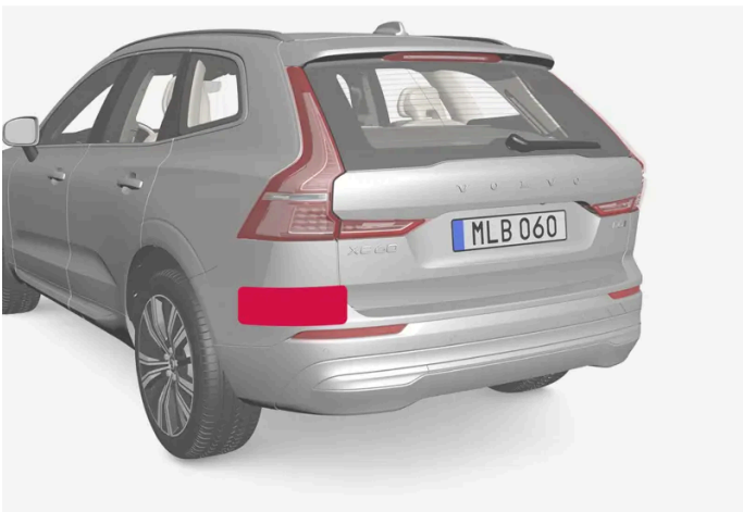
Locatie van de radarsensoren aan de achterzijde
