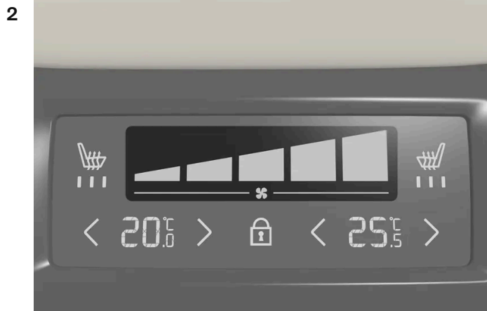
Ventilatorregeling op klimaatpaneel achter op tunnelconsole.
