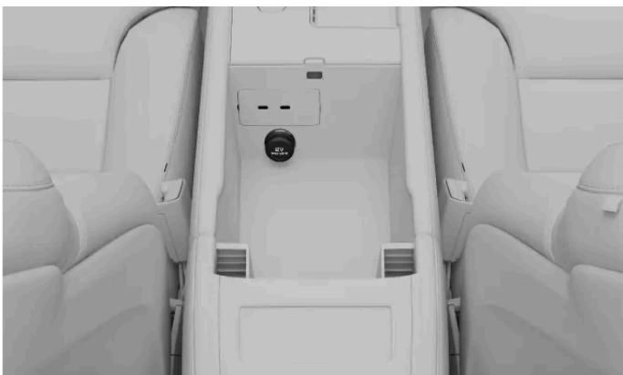
De 12V-aansluiting in de tunnelconsole
