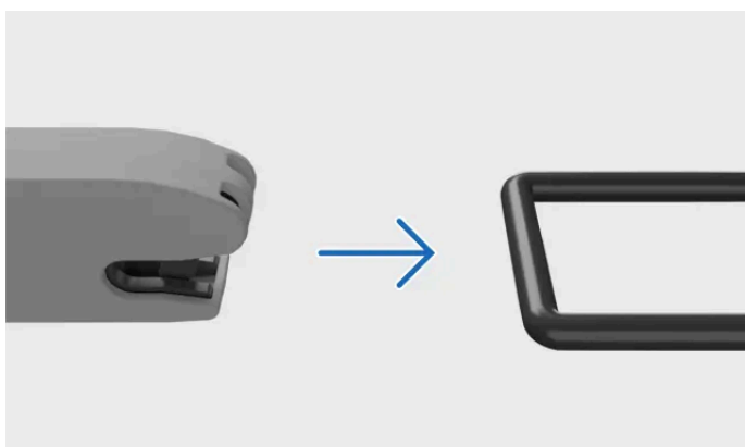
Bevestiging aan een ISOFIX-verankeringspunt
