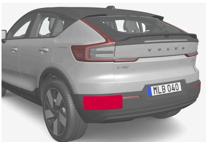
Umieszczenie tylnych modułów radarowych
