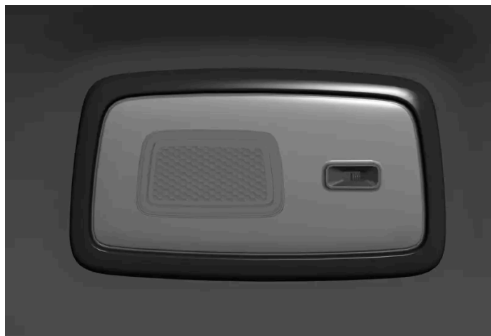
Lampki do czytania nad tylnymi siedzeniami.
