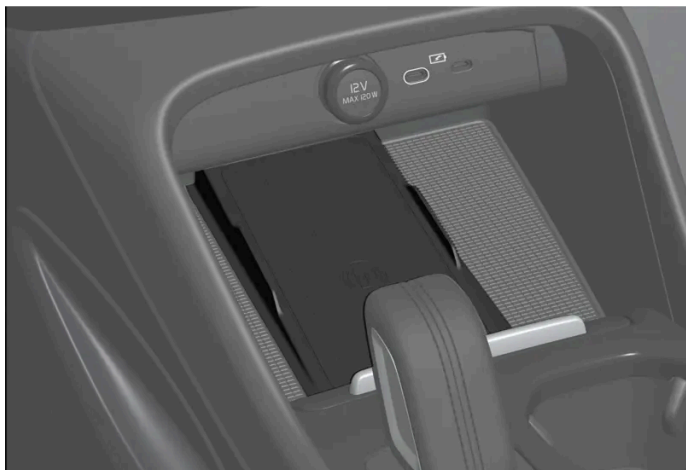
Bezprzewodowa ładowarka telefonu przed dźwignią zmiany biegów
