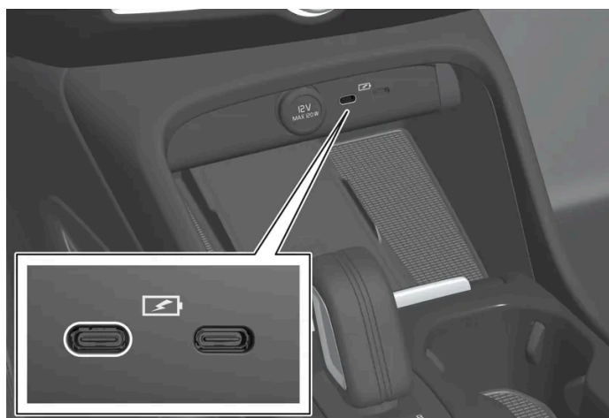
Gniazda USB (typu C), siedzenie przednie.
