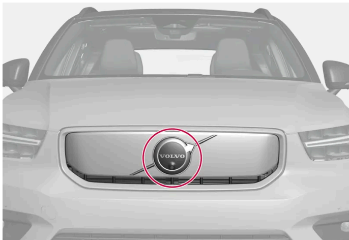
Umieszczenie przedniego modułu radarowego
