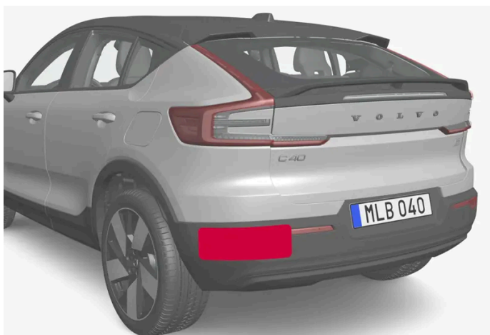
Umiejscowienie tylnych modułów radarowych
