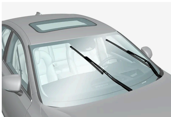
Pióra wycieraczek w pozycji serwisowej.
