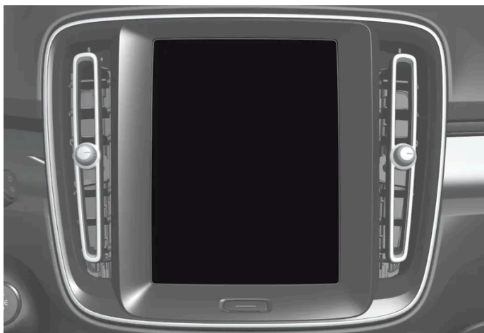
Przycisk strony głównej wyświetlacza centralnego.
