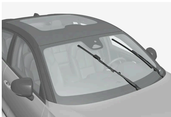
Pióra wycieraczek w pozycji serwisowej.
