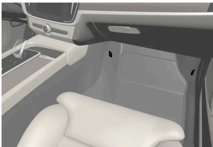
Rozmieszczenie zaczepów mocujących w fotelu przednim.
