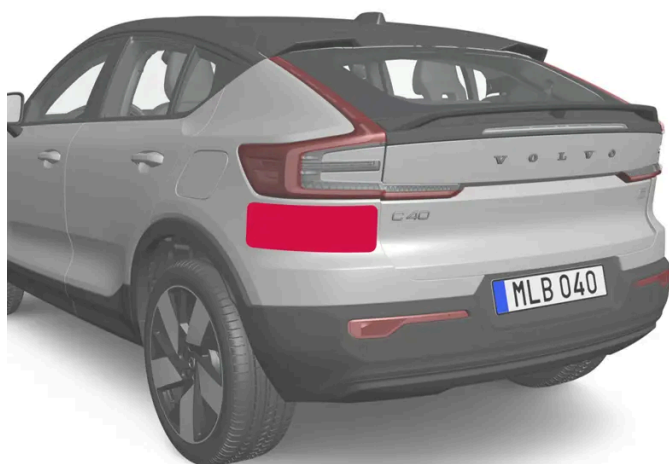
Umiejscowienie tylnych modułów radarowych
