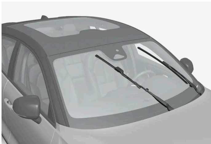
Pióra wycieraczek w pozycji serwisowej.
