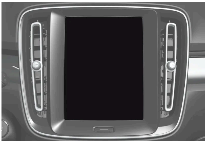
Przycisk strony głównej wyświetlacza centralnego.
