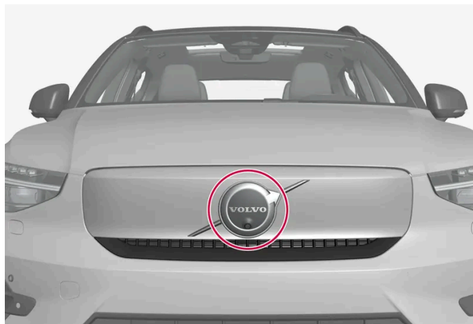
Umiejscowienie przedniego modułu radarowego
