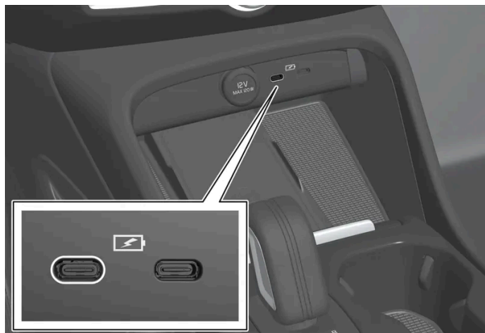
Gniazda USB (typu C), siedzenie przednie.
