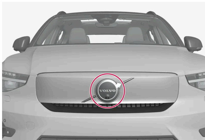
Umieszczenie przedniego modułu radarowego
