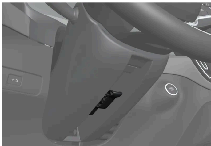
Dźwignia do regulacji kierownicy.
