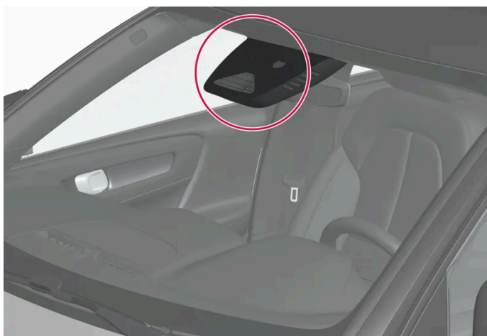
Umiejscowienie modułu kamery
