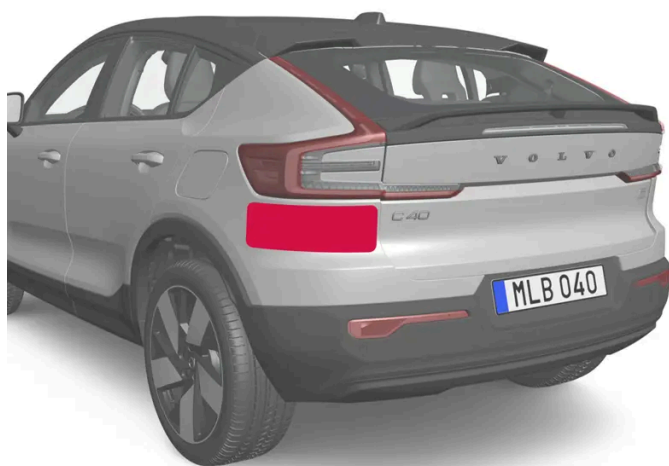
Umieszczenie tylnych modułów radarowych
