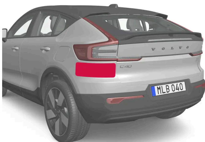
Umiejscowienie tylnych modułów radarowych
