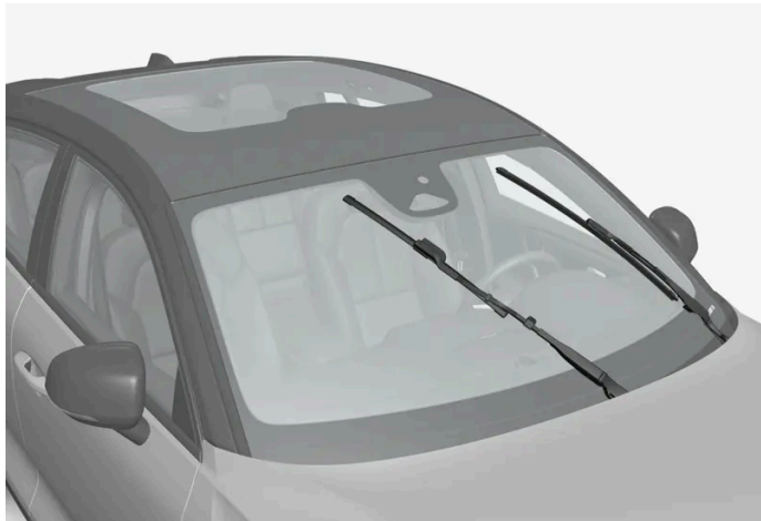
Pióra wycieraczek w pozycji serwisowej.
