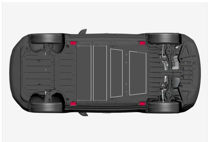
Punkty do podnoszenia samochodu przy użyciu podnośnika.
