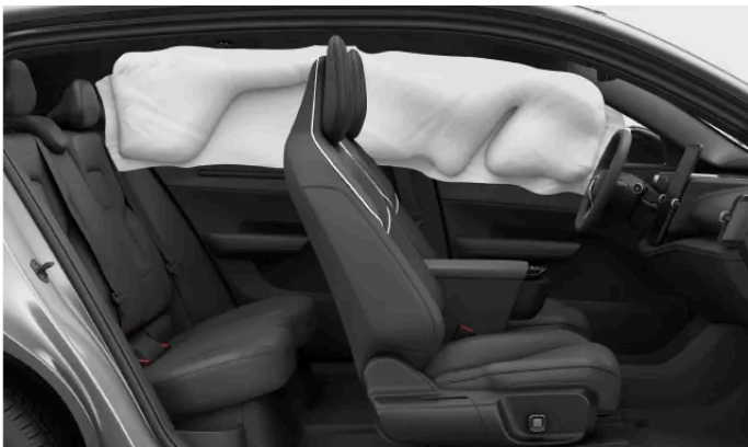
Kurtyna powietrzna rozwinięta po jednej stronie samochodu.
