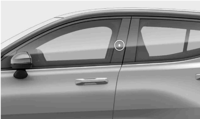
Obszar wykrywania kluczyka na słupku drzwiowym
