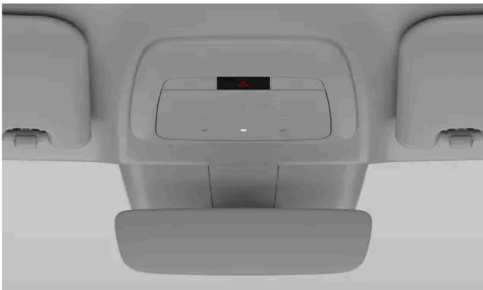
Położenie przycisku świateł awaryjnych na konsoli sufitowej
