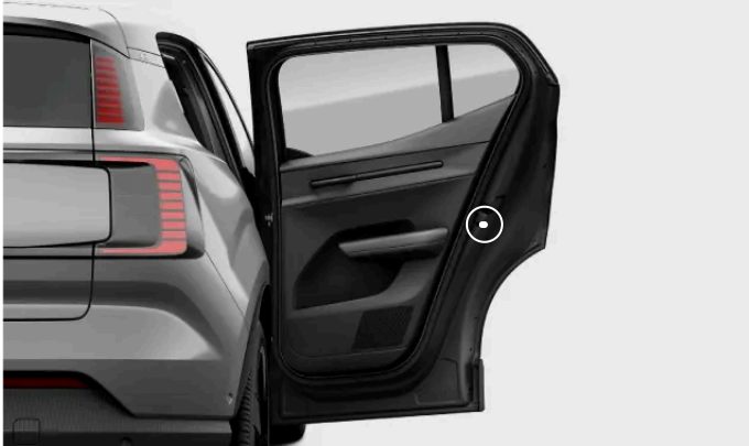
Położenie przełącznika blokady tylnych drzwi.
