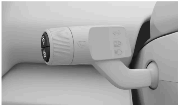
Przyciski spryskiwaczy na lewej dźwigni przy kierownicy.
