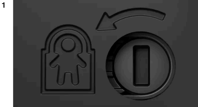
Blokada tylnych drzwi ze strzałką wskazującą kierunek obrotu w celu włączenia.
