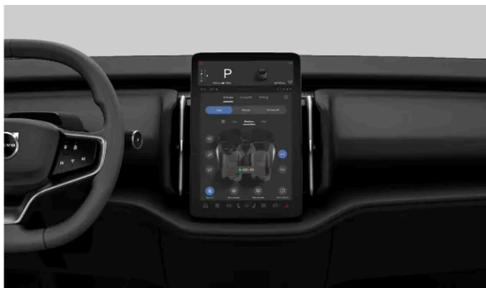
Elementy sterujące klimatyzacją na wyświetlaczu
