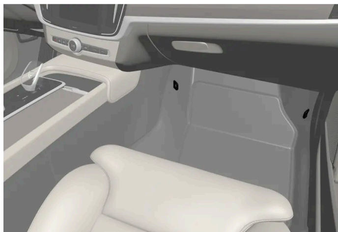
Rozmieszczenie zaczepów mocujących w fotelu przednim.
