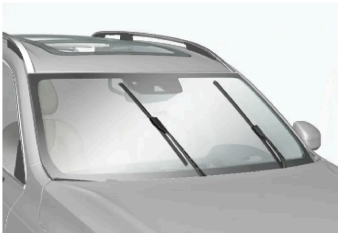
Pióra wycieraczek w pozycji serwisowej.
