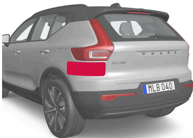
Umiejscowienie tylnych modułów radarowych
