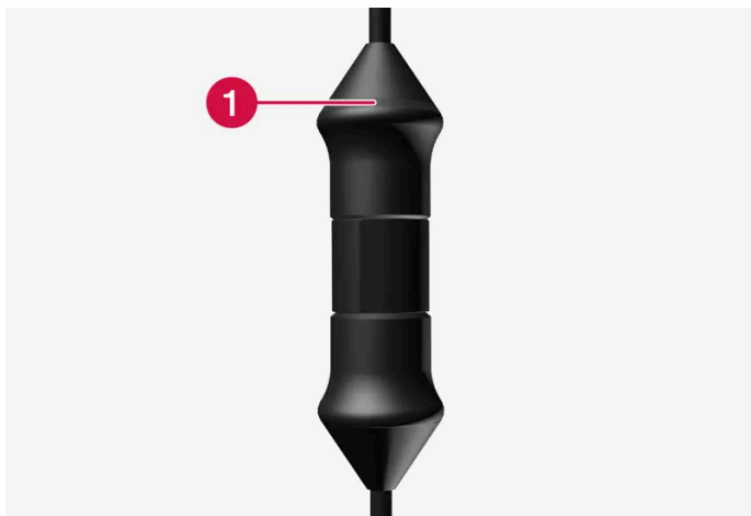
Lampka LED skrzynki sterowniczej [2] .
