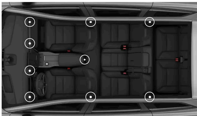
Rozmieszczenie regulowanych nawiewów
