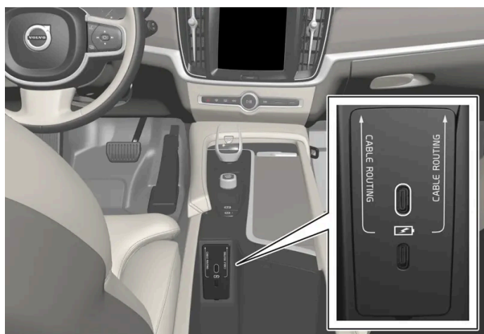
Gniazda USB do ładowania urządzeń.
