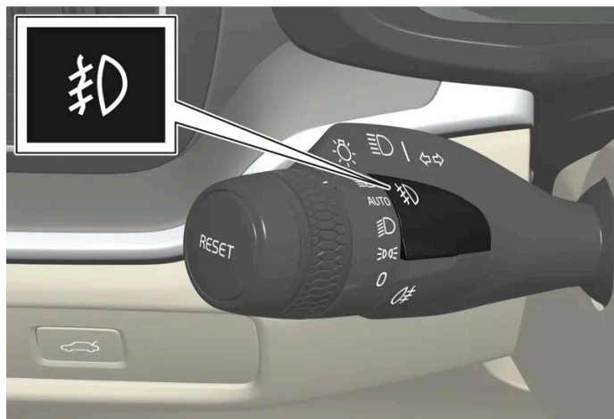
Wyłącznik przednich świateł przeciwmgielnych.
