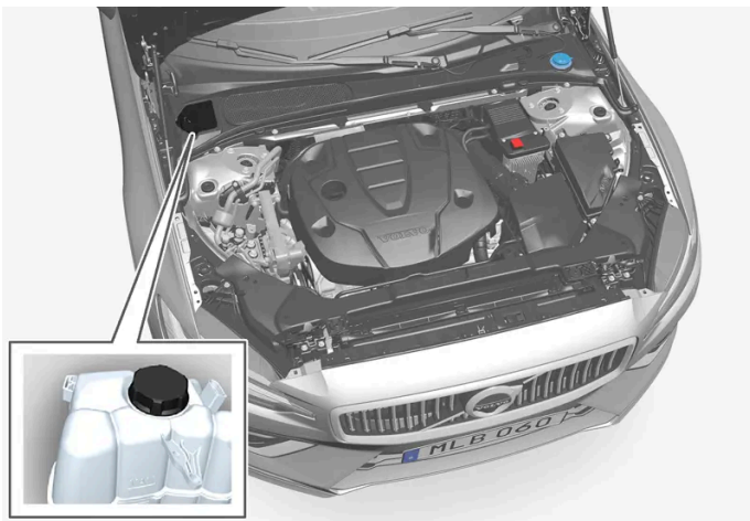
Zbiornik wyrównawczy płynu chłodzącego
