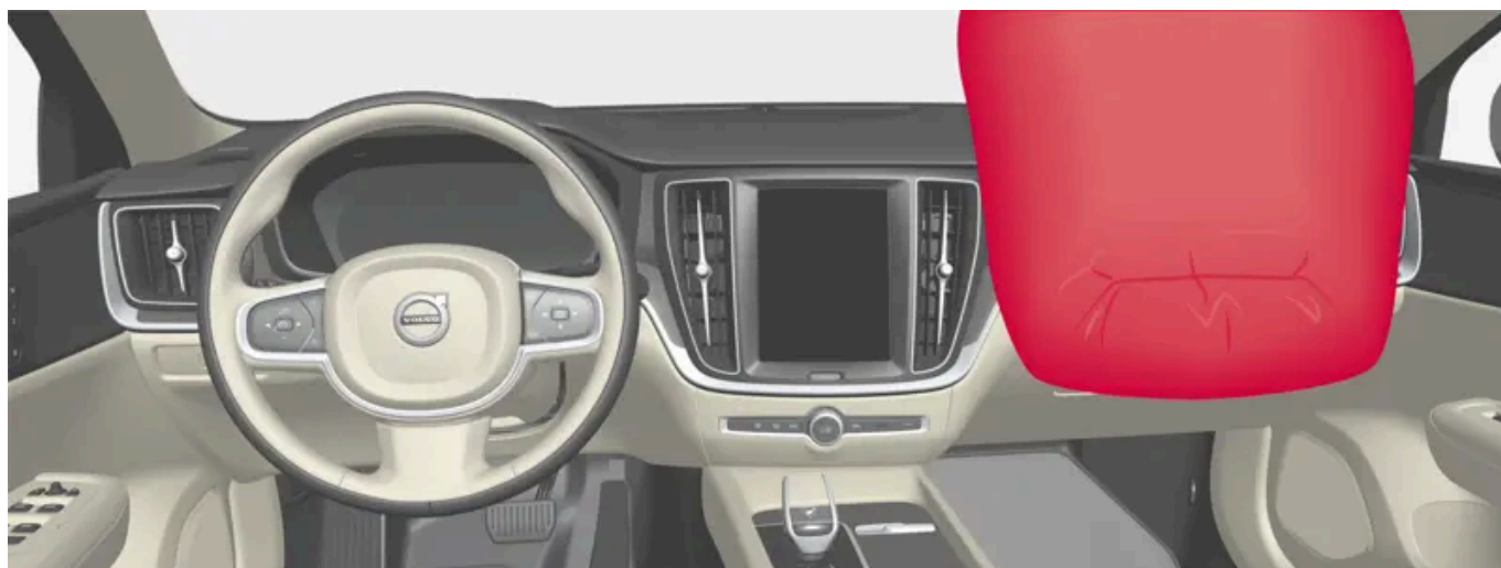
Czołowa poduszka powietrzna pasażera przedniego fotela.
