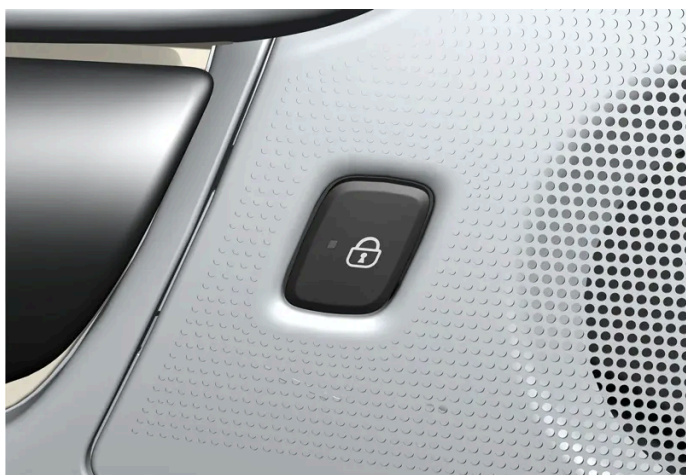
Przycisk zablokowania z diodą wskaźnikową w drzwiach tylnych.
