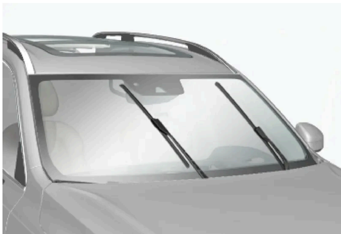
Pióra wycieraczek w pozycji serwisowej.
