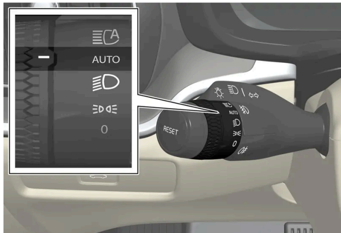
Pierścień obrotowy na dźwigni przełącznika zespolonego w położeniu AUTO.
