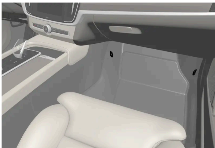
Rozmieszczenie zaczepów mocujących w fotelu przednim.
