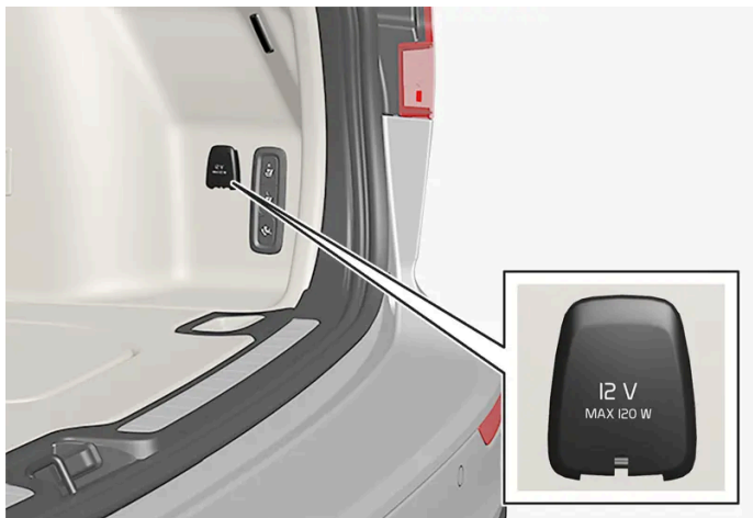
Gniazdo elektryczne 12 V w przestrzeni bagażowej*.
